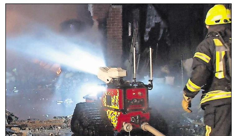
Spezialgerät: Zur Brandbekämpfung der unübersichtlichen, mit Waren voll gestellten Halle wurden auch Löschroboter eingesetzt.
